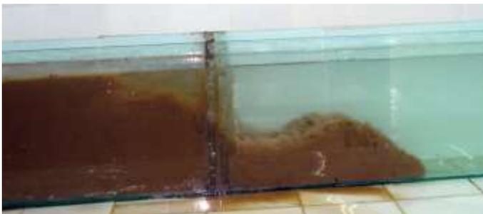
**Figure 43 : Courant de densité dans un canal rectangulaire (Remini, 2019)**
