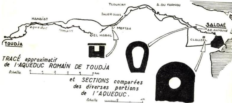
**Figure 14 : Tracé de l'aqueduc de Toudja (Birebent ,1964)**
