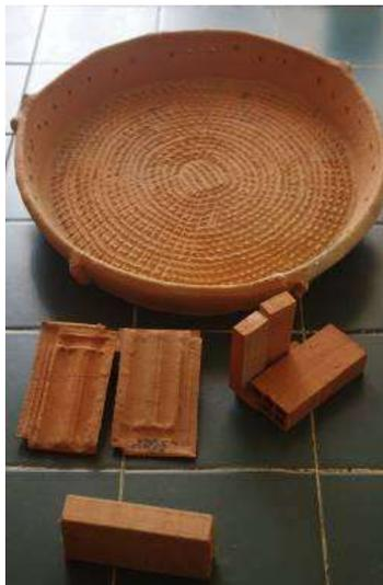
**Figure 35 : Tuiles, briques et Tadjine fabriquées à partir de la vase du barrage de SMBA (Photo. Remini, 2018)**
