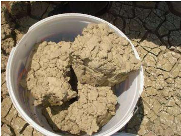
**Figure 30 : Echantillon de vase prélevée à la sortie de la vanne gauche (Photo. Remini, 2018)**
