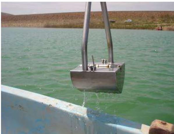
**Figure 5 : Préleveur d'échantillons de vase (Photo. Remini, 2013)**
